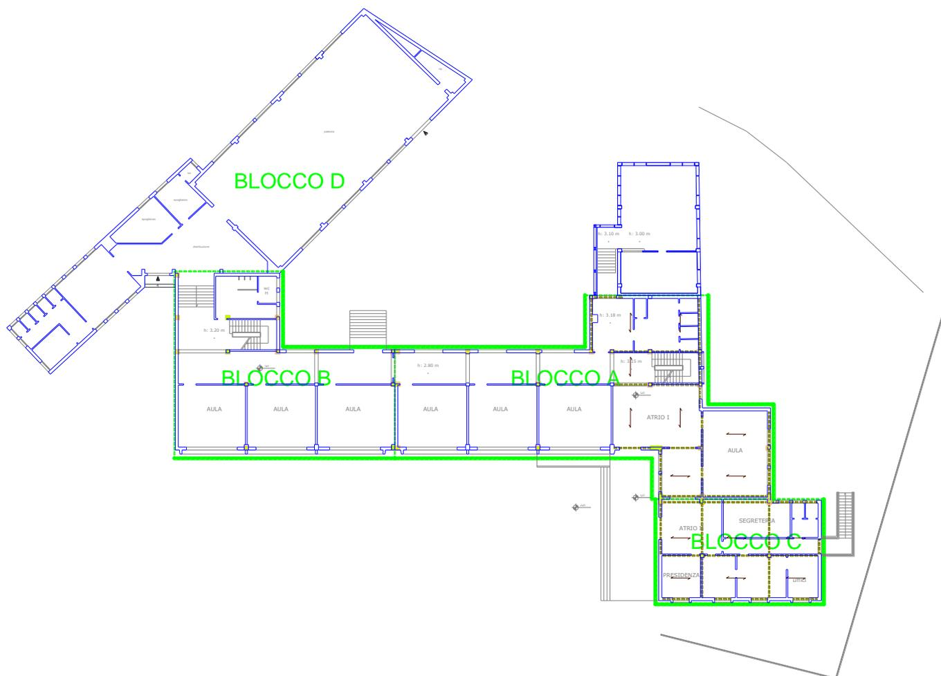
Figura 2 – Planimetria del Plesso Scolastico ed individuazione delle unità strutturali.
