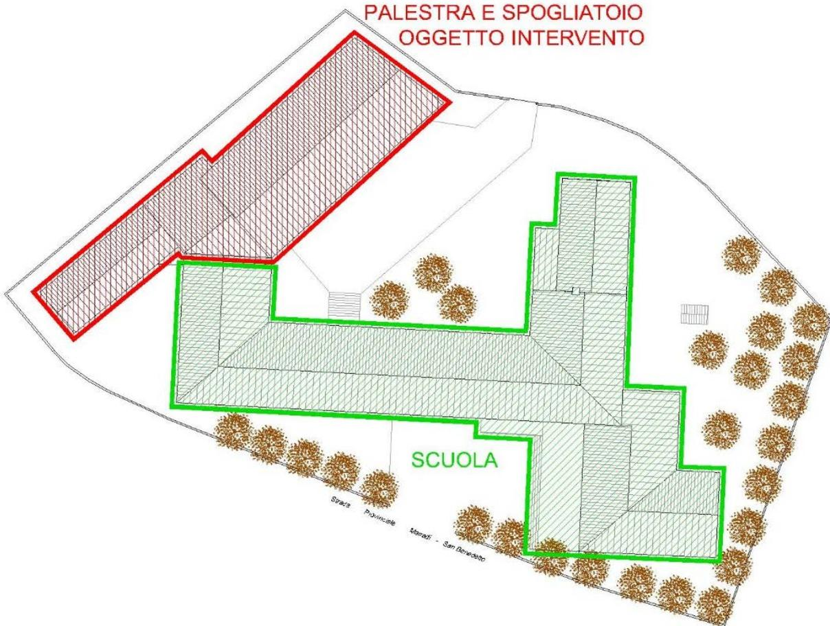
Figura 2 – Planimetria del Plesso Scolastico ed individuazione delle unità strutturali oggetto dell'intervento.
